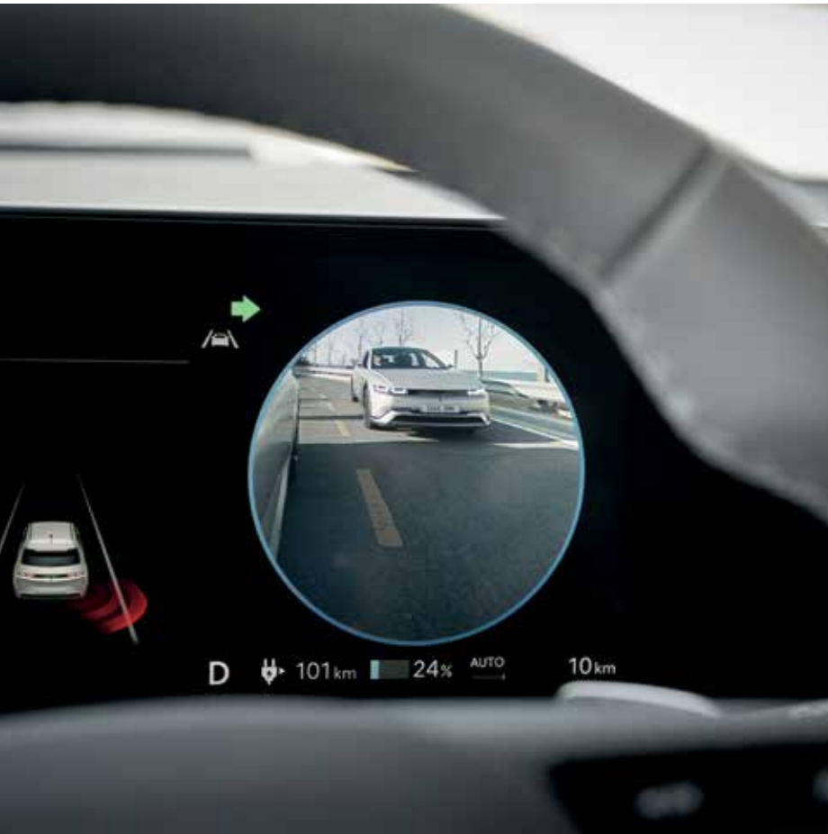
BVM (Blindspot View Monitor), caméra angle mort
