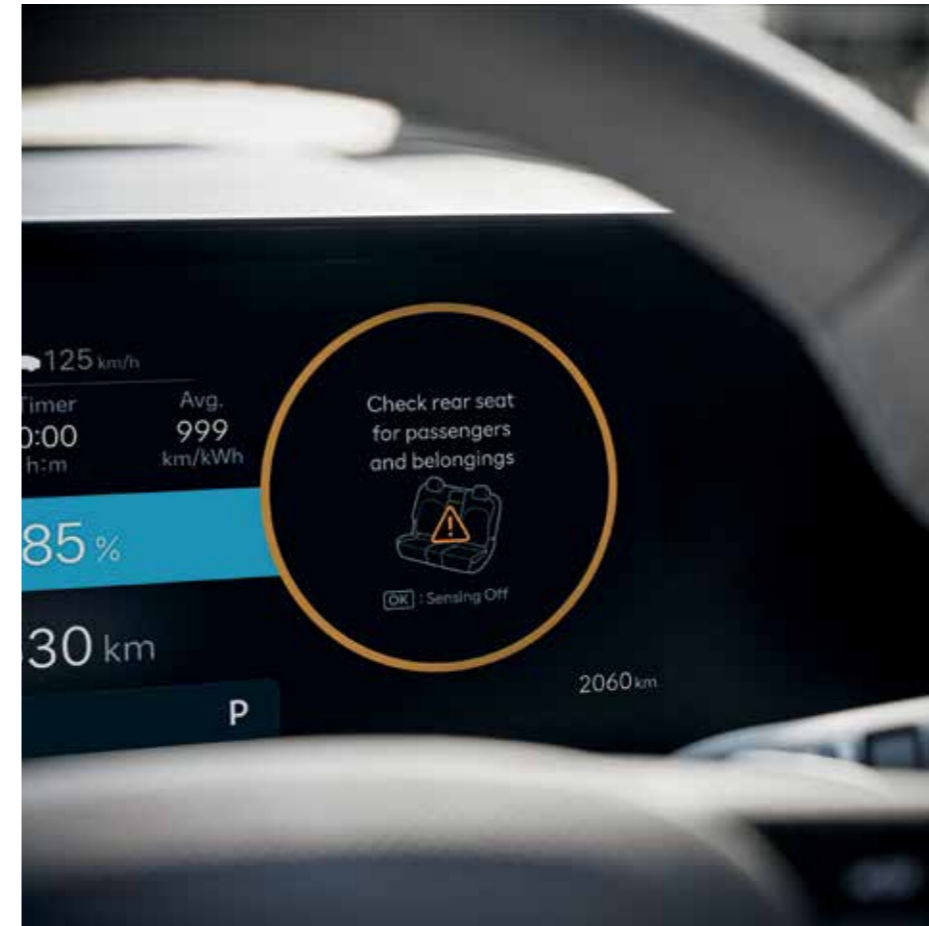
ROA (Rear Occupant Alert), détection passager arrière sans capteur
