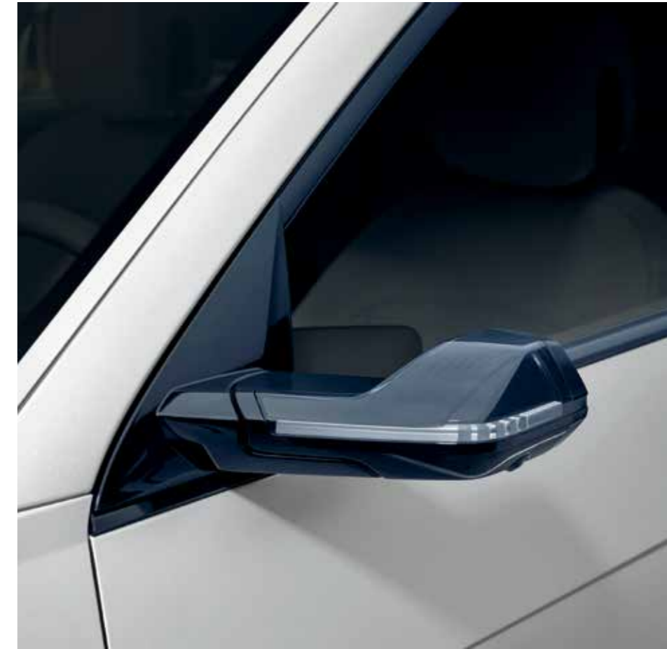
Rétroviseurs extérieurs numériques aérodynamiques (DSM)
