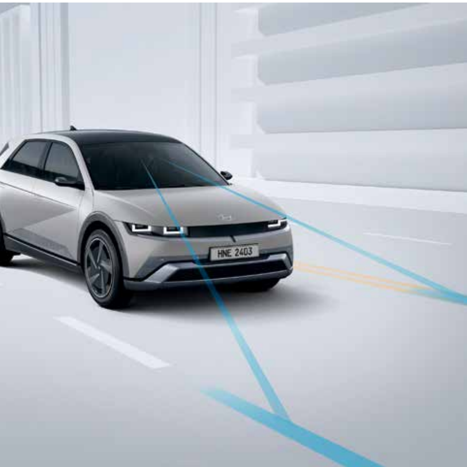
Lane Keeping Assist (LKA) Lorsque le conducteur roule à une certaine vitesse et qu'il quitte une voie sans que le clignotant soit allumé, un avertissement est émis. Lorsqu'une déviation de voie est détectée, le système assiste automatiquement la direction pour empêcher la sortie de voie.
