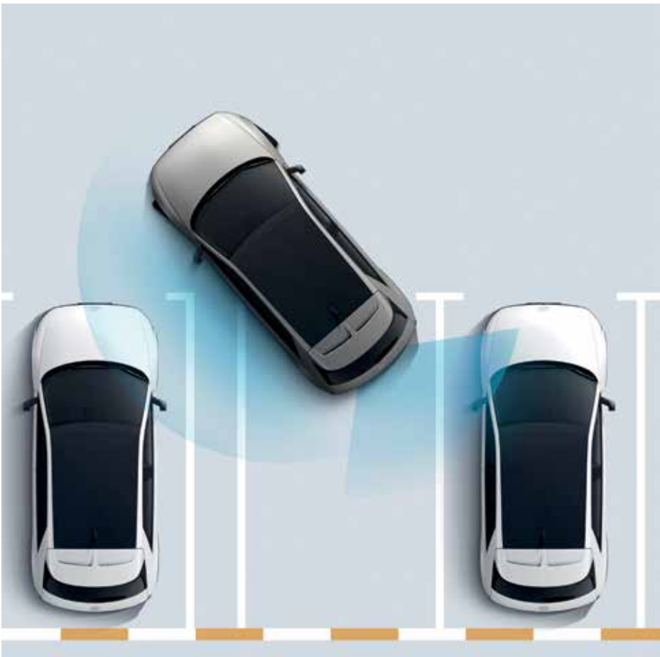
Forward/Side/Reverse/ Parking Distance Warning (PDW) Forward/Side/Reverse Parking Distance Warning (PDW) prévient des collisions avec des objets situés autour du véhicule à faible vitesse.
