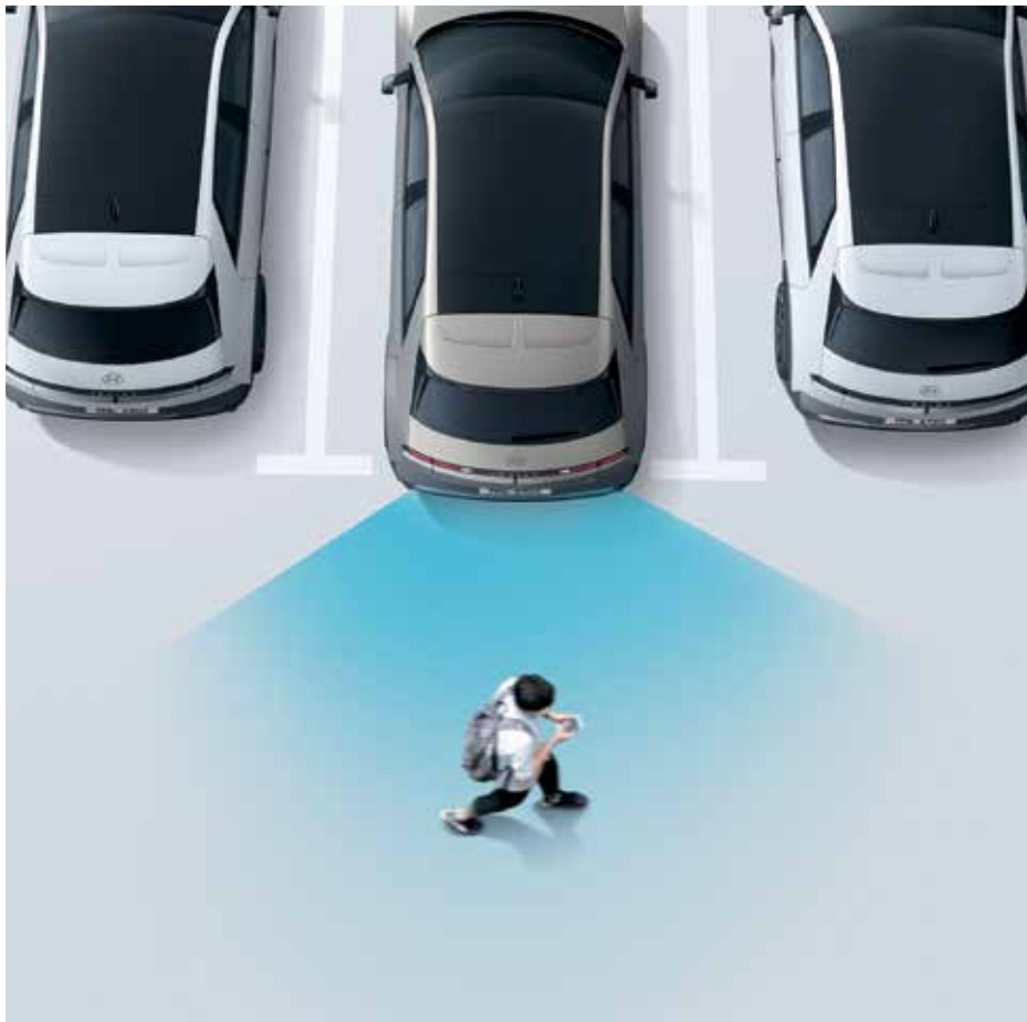
Parking Collision-Avoidance Assist (PCA) Parking Collision-Avoidance Assist (PCA) pour stationnement avant/arrière/latéral avertit et assiste en cas de freinage d'urgence s'il y a un risque de collision avec un objet à l'arrière lors de la marche arrière.
