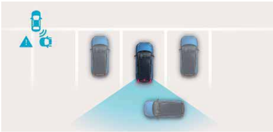
En marche arrière, le Rear Cross Traffic Collision-avoidance Assist avertit le conducteur lorsque des véhicules s’approchent sur le côté et freine automatiquement en cas de nécessité.
